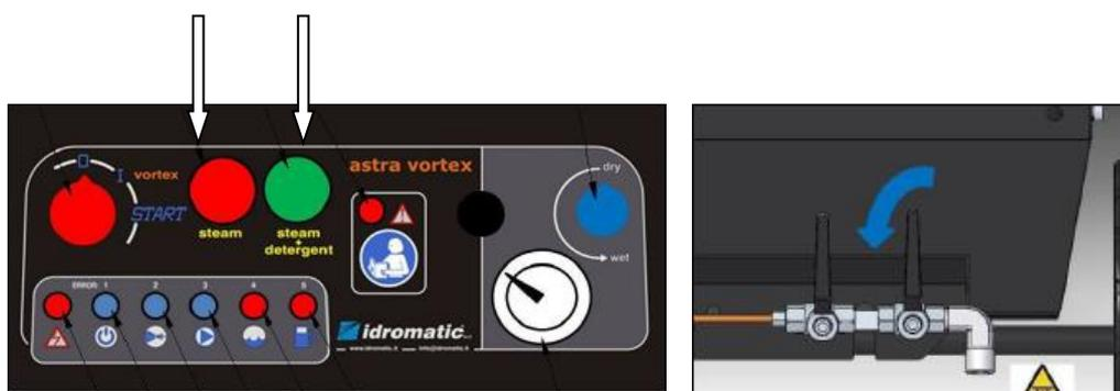
La macchina inizierà a caricare acqua e prodotto chimico fino al riempimento della caldaia
